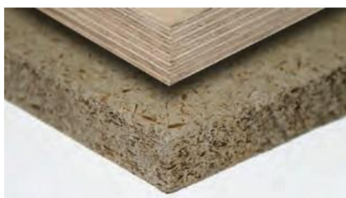
Напольные плиты из многослойной фанеры или ЦСП
